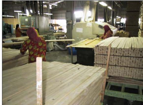
Ensuite, les bandeaux sont collés et placés dans un moulin de collage. On remplit suivant la largeur désirée du panneau.
