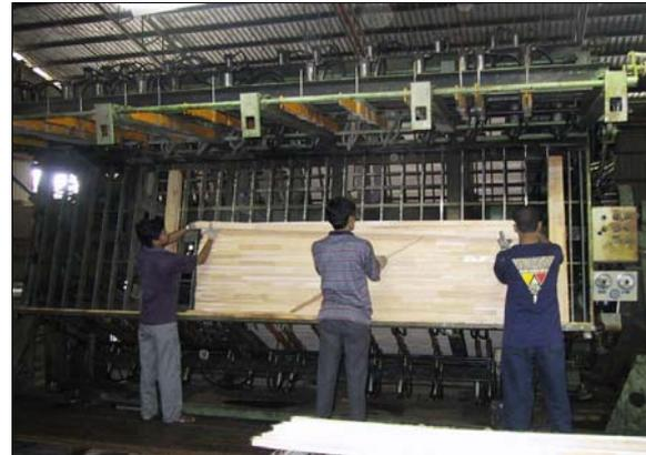
Une presse hydraulique (jusqu'à 120 tonnes) presse les bandeaux ensemble et le moulin tourne pour le panneau suivant.
