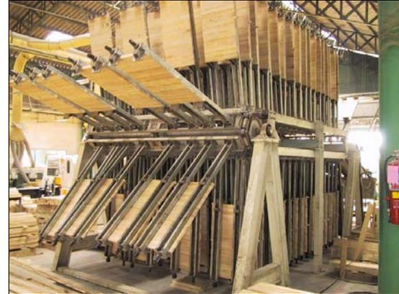
Les panneaux sortent du moulin et sont mis sur un bloc pour passer dans le séchoir **pour la troisième fois**. Plus vite la colle sèche, meilleur est la tenue de la colle et le risque de décoloration ou de tâches dans le bois sont écartés. Sorti du séchoir, le panneau est centré et scié parfaitement sur mesure. La ponceuse finit le panneau sur l'épaisseur. Standard : dessus et dessous Grain 180.
