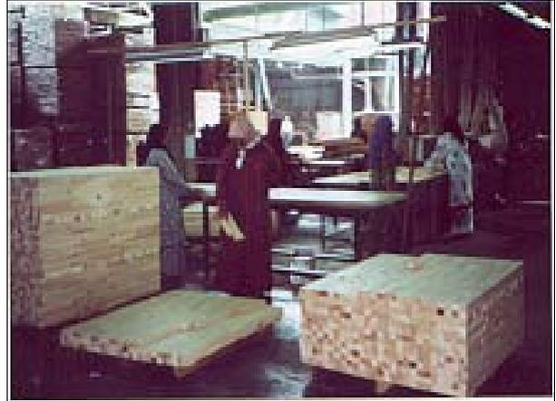
Les lames sont prêtes pour l'aboutage. Les lames passent dans une machine qui fraise les petits « doigts » aux extrémités. Une deuxième machine projette automatiquement de la colle sur les doigts. La presse pousse le tout ensemble pour avoir des joints bien fermés. Les doigts sont uniquement visibles sur les côtés. Sur le dessus seulement une ligne est visible. Après aboutage, nous avons de longs bandeaux qui sont mis sur lattes pour passer une seconde fois dans le séchoir.
